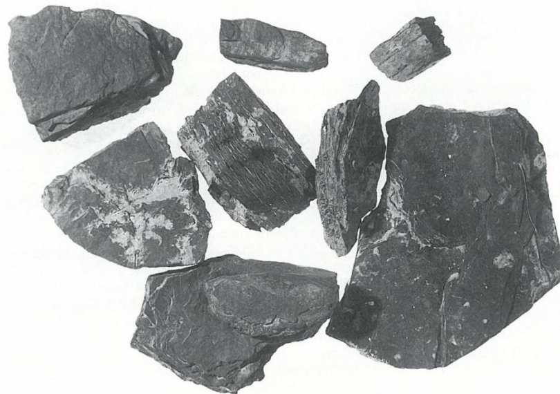
Obr. 17. Hutnická struska a zestruskovatělý výmaz železářské pece. Nálezy F. Sedláčka. 1 hutnická struska (Mšec I): A řez ukazující vnitřní strukturu, B ztuhlé prameny tekoucí strusky, 1:1; 2 výmaz pece (Mšec III): C, D vrstvy staršího a mladšího výmazu, E zestruskovatělá vnitřní strana, 1:2. – Bloomery slag and furnace lining. Finds by F. Sedláček. 1 bloomery slag (Mšec I): A section showing the inner structure, B solidified strands of molten slag, scale 1:1; 2 furnace lining (Mšec III): C, D layers of the earlier and later lining, E slaggy inner surface, scale 1:2.
